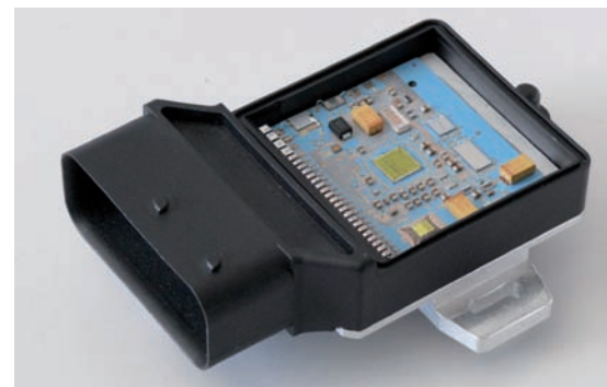
Bild 2: Gut geschützte Automobilelektronik mit Steckeranschluss
